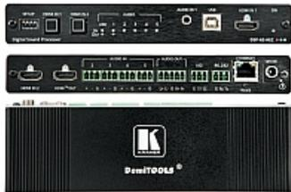
DSP-62-AEC gehört zur Kramer DSP XSPeXperience Familie. DSP-62-AEC ist ein hochentwickelter professioneller 6x2 Audio-Matrix-Umschalter mit Multi-Kanal DSP, AEC (Acoustic Echo Cancellation), HDMI-Auskopplung und klassenkonformer USB Audio-Schnittstelle. Die anwenderfreundliche Grafikoberfläche mit zahlreichen Einstellungsmöglichkeiten ermöglicht eine intuitive und leichte Konfiguration Ihres Audio-Systems bis ins kleinste Detail
